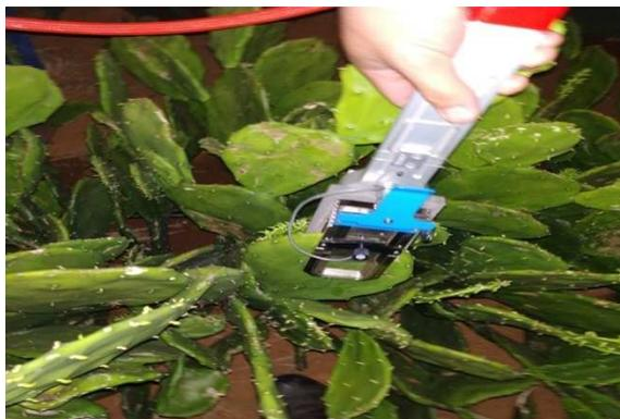
**Figura 8:** Leitura da fotossíntese, trocas gasosas, em acessos de *Opuntia* spp. utilizando aparelho contendo analisador de gás infravermelho (IRGA).
